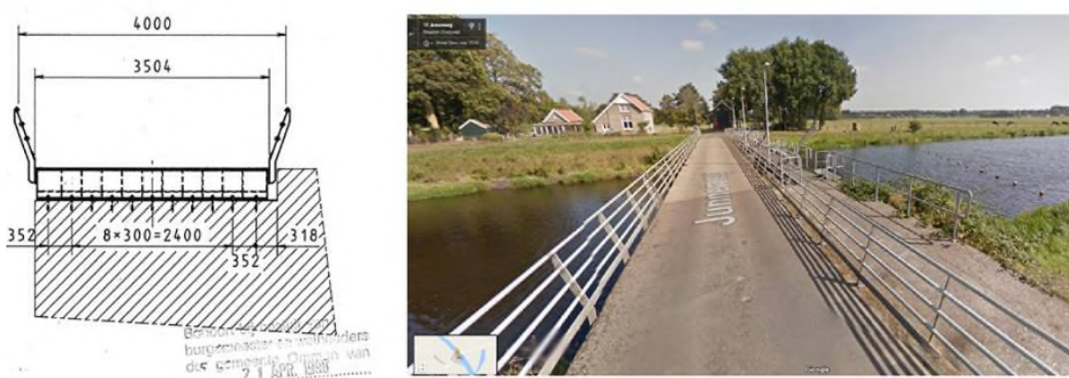
Figuur 15: Bestaande dwarsdoorsnede brugdek / Streetview Junnerweg
