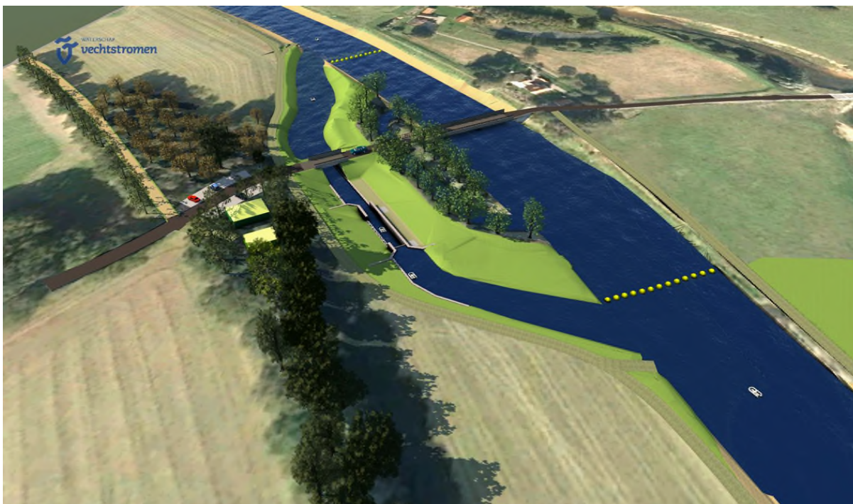
Figuur 1: Impressie van de stuw bij Junne met nieuw gerealiseerde sluis ( https://natuurlijkomen.nl )
